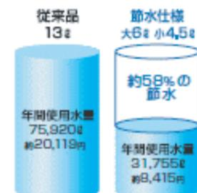
年間使用水道料金は約20,119円から約8,415円に節約できます。ノンホールドハンドルの採用で一定量の水を流すので、知らないうちに効果的に節水ができます。
