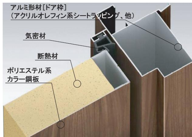
アルミ型材枠とドア厚42mmの断熱パネルドアに主に複層ガラスを採用しました。
